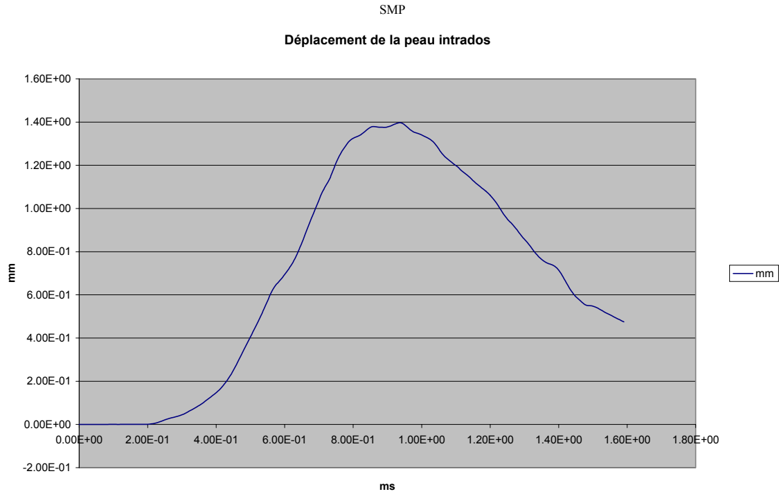
Figure n°18 – Déplacements mesurés sur la peau intrados, au lieu du coup de bélier
